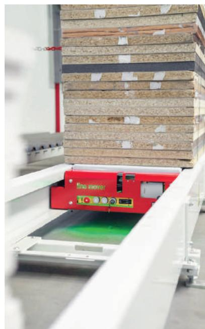
**Die drahtlose Sicherheits-SPS Safety Simplifier wurde direkt in das Transport-Shuttle integriert.**
