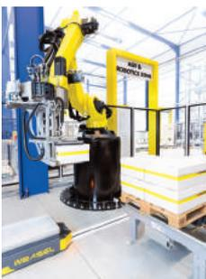
SSI Schäfer zeigt auf der Logimat ein breites Lösungsspektrum für automatisches Kommissionieren und Robotik, z.B. eine hochdynamische Lösung zur effizienten Einzelstückkommissionierung oder ein kompaktes Modul zur vollautomatischen End-of-Line-Palettierung.
