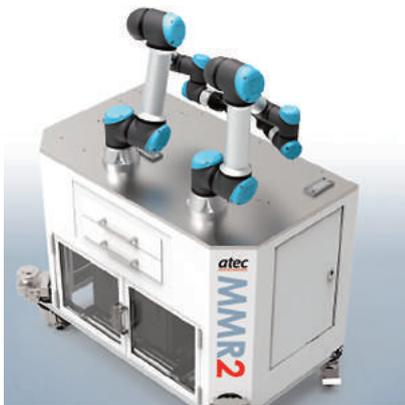
Für die aufwendige Produktion von speziellen Zangen in der Medizintechnik hat Atec den mobilen Montagroboter MMR2 entwickelt. Aufgabenstellung war die automatisierte Montage von insgesamt drei Einzelteilen aus Kunststoff und Metall. Durch zwei UR-Roboter werden die Zangen nun im 10s-Takt montiert. Die Zuführung der Einzelteile erfolgt sowohl als Schüttgut über einen Feeder, als auch über ein Förderband direkt aus der vorgelagerten Spritzgussmaschine.
