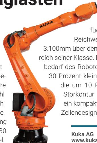
Außerdem verfügt er mit einer Reichweite von maximal 3.100mm über den größten Arbeitsbereich seiner Klasse. Der geringere Platzbedarf des Roboters durch einen um 30 Prozent kleineren Footprint und die um 10 Prozent schlankere Störkontur ermöglicht zudem ein kompaktes Zellenesign.
