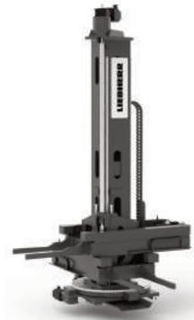
Liebherr hat das modulare Palettenhandhabungssystem PHS Allround jetzt mit einem Doppellader ausgestattet. Die neue Variante verfügt über einen Fahrturm mit zweiter Teleskoppabel. Diese ist um 90° versetzt und kann in einer Fahrt ein Rohteil mitnehmen und die Maschine nach dem Entladen neu beladen. Das ist besonders interessant für direktbeladene Bearbeitungszentren ohne Palettenwechsler oder
