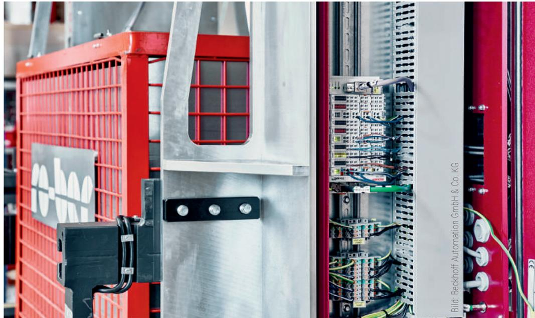
*Das modulare Ethercat-Klemmensystem lässt sich auch in den dezentralen Schaltkästen an den Gabelgreifern unterbringen.*
