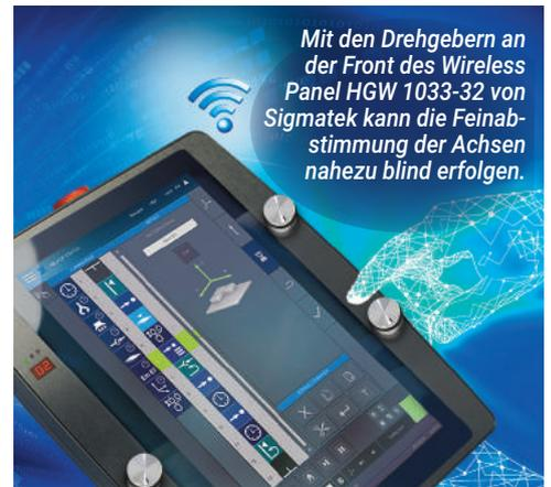
Mit den Drehgebern an der Front des Wireless Panel HGW 1033-32 von Sigmatek kann die Feinabstimmung der Achsen nahezu blind erfolgen.
