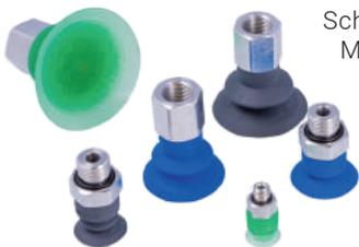
Schmalz hat mit den neuen Modellen SFF und SFB1 einen Vakuumsauggreifer entwickelt, der dünne, flexible Verpackungen und Werkstücke greifen kann, ohne die Oberfläche zu deformieren oder Abdrücke zurückzulassen. Das Unternehmen kombiniert dafür eine weiche Dichtlippe mit einer stabilisierenden Abstützfläche im Inneren des Sauggreifers. Neu ist auch die Wabenstruktur von Dichtlippe und Abstützelement. Sie sorgt für eine gute Vakuumverteilung und eine sichere Bauteilhandhabung bei hoher Saugkraft.
