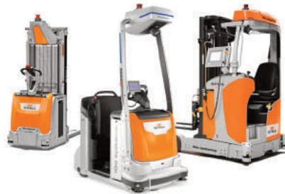
Fahrzeuge mit dem Menschen. Zudem wird auf der Messe die Weiterentwicklung des autonom fahrenden Kommissionierers iGo Neo CX 20 vorgestellt. Sie basiert auf der neuen OPX-Baureihe, die nicht nur eine größere Fahrzeugauswahl, sondern auch eine Reihe neuer Lösungen für eine bessere Steuerung und hohe Verfügbarkeit mit sich bringt.
