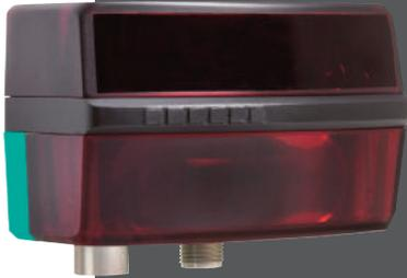
Pepperl+Fuchs hat den Mehrlagenscanner R2300 vorgestellt. Das robuste und kompakte Gerät ist mit präziser Lasermesstechnik auf hohe Leistungsdichte ausgelegt. Es kann vier Scanebenen auswerten und Objekte in Länge, Breite und Höhe detektieren bzw. messen. Der Scanner verfügt über einen Öffnungswinkel von 100°, bietet Messbereiche bis 10m auf helle und bis zu 4m auf dunkle Oberflächen, eine Messrate von 50kHz sowie wählbare Scan-
