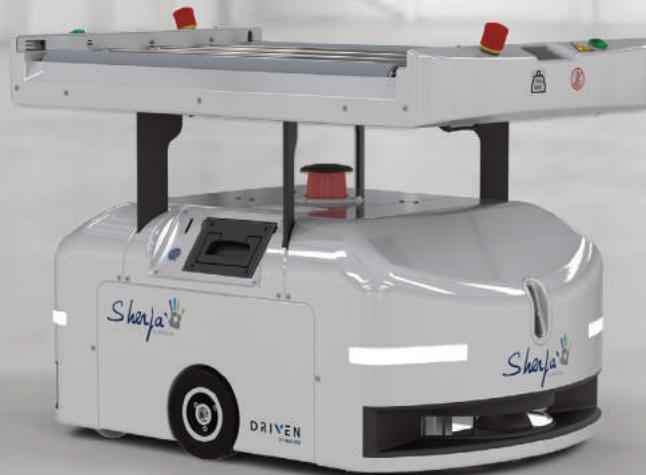
Der kollaborative Roboter Sherpa von Norcan für Handling- und Kommissionieraufgaben ist mit einer Roller-Drive-Förderlösung von Interroll ausgerüstet.
