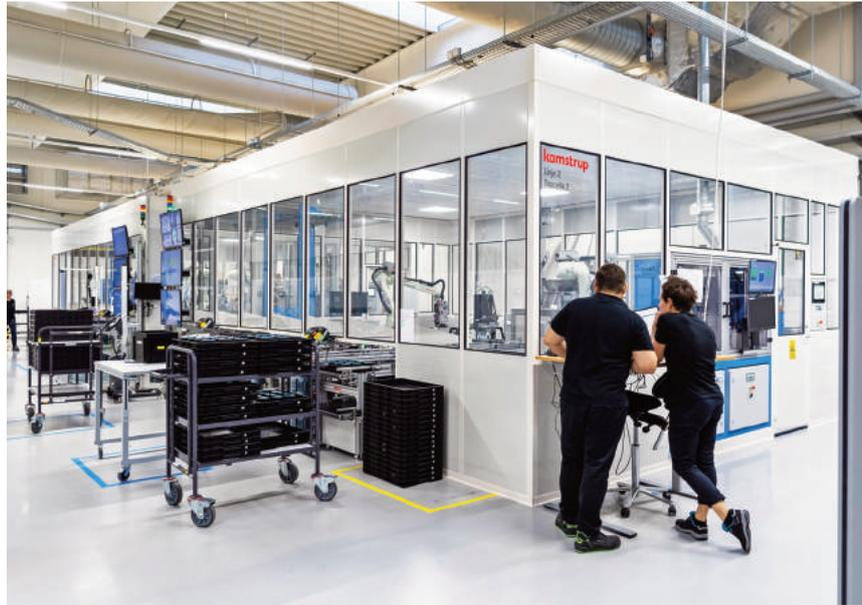
In der Wasserzählerfertigung bei Kamstrup übernehmen Roboter bei großen Losgrößen sämtliche Montageschritte.
