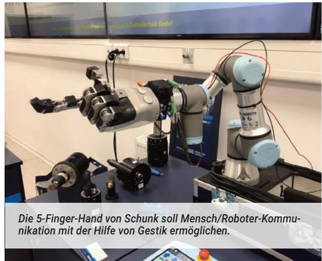
Die 5-Finger-Hand von Schunk soll Mensch/Roboter-Kommunikation mit der Hilfe von Gestik ermöglichen.
