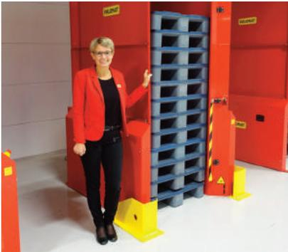
Das neue Palettenmagazin AMR von Palomat ist für einen mobilen Roboter von MIR konstruiert. Er kann direkt mit dem Magazin kommunizieren, das als Palettenpuffer und Dockingstation dient. So soll ein effizienter Flow in der Logistikkette sichergestellt werden. Mit dem vollautomatisierten Palettenmagazin kann der mobile Roboter alle notwendigen Paletten abholen und abliefern, ohne dass Mitarbeiter einbezogen
