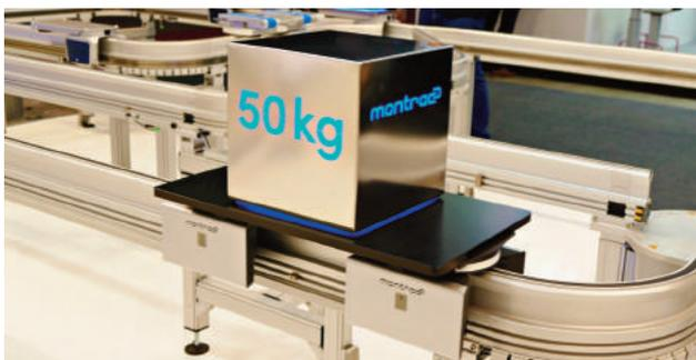
Die autonomen Sensormodule der Shuttle-Generation MSH5 von Montratec überwacht Kurven- und Rückwärtsfahrten sowie die Fahrstrecke.
