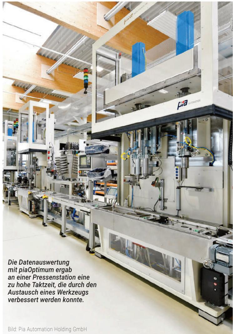
**Die Datenauswertung mit piaOptimum ergab an einer Pressenstation eine zu hohe Taktzeit, die durch den Austausch eines Werkzeugs verbessert werden konnte.**
