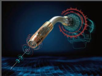
Das Assistenzsystem WireSense von Fronius benötigt keine zusätzlichen Sensorhardwarekomponenten, stattdessen nutzt es die Drahtelektrode als Sensor. Mit einer reversierenden Drahtbewegung tastet der Brenner das Bauteil ab und das Schweißsystem sendet die Höheninformation bzw. die Kantenposition an den Roboter. Handelt es sich z.B. um eine Überlappnaht, kann so die zu verschweißende Kantenposition genau definiert bzw. auf eventuelle Abweichungen reagiert werden. Der Roboter passt
