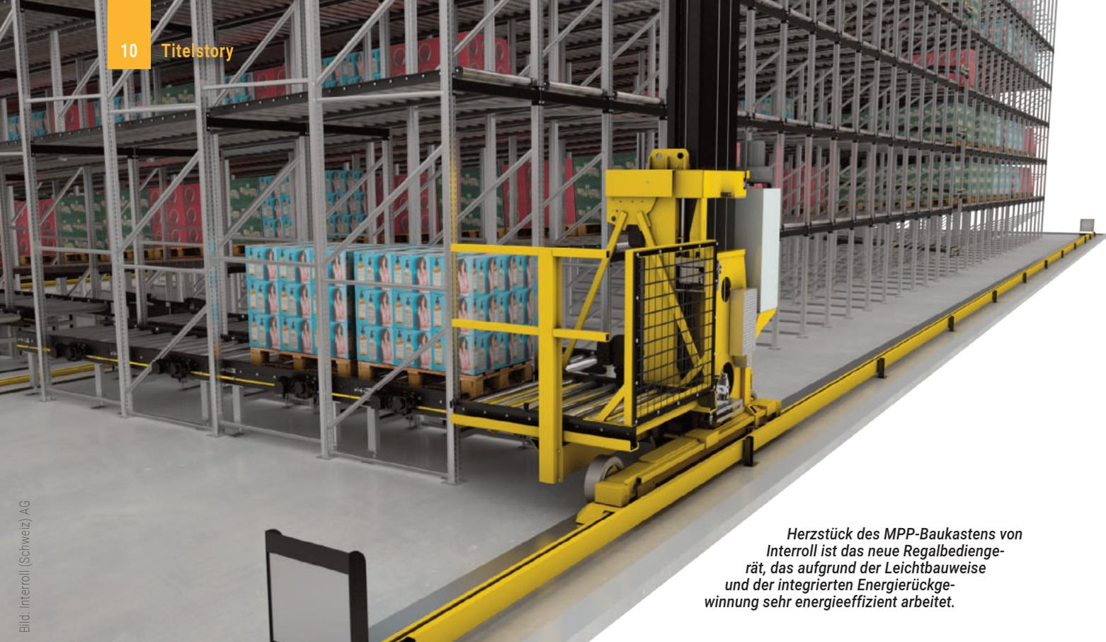
**Herzstück des MPP-Baukastens von Interroll ist das neue Regalbediengerät, das aufgrund der Leichtbauweise und der integrierten Energierückgewinnung sehr energieeffizient arbeitet.**
