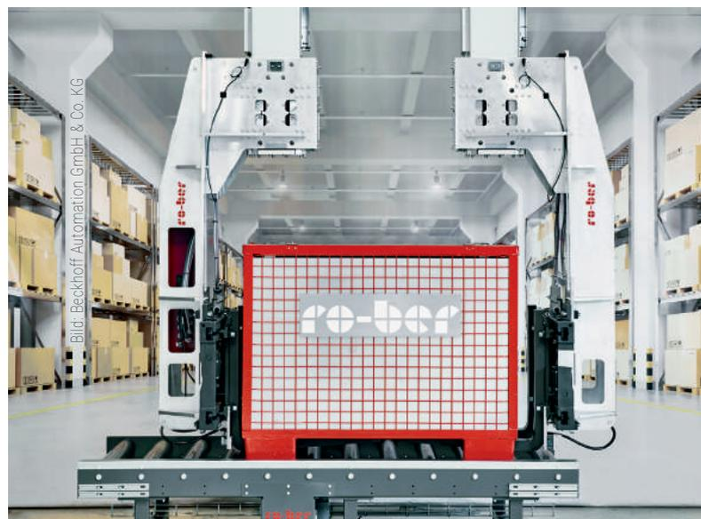
Das Robotersystem Twin-Gantry mit einer Traglast von 1.500kg wurde für die Handhabung von Großladungsträgern zur Routenzugbelastung entwickelt.
