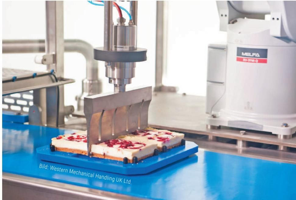
**Mit Ultraschall vibrierende Messerklingen können die unterschiedlichsten Materialien schnell, mit hoher Genauigkeit und sehr geringer Druckausübung schneiden.**
