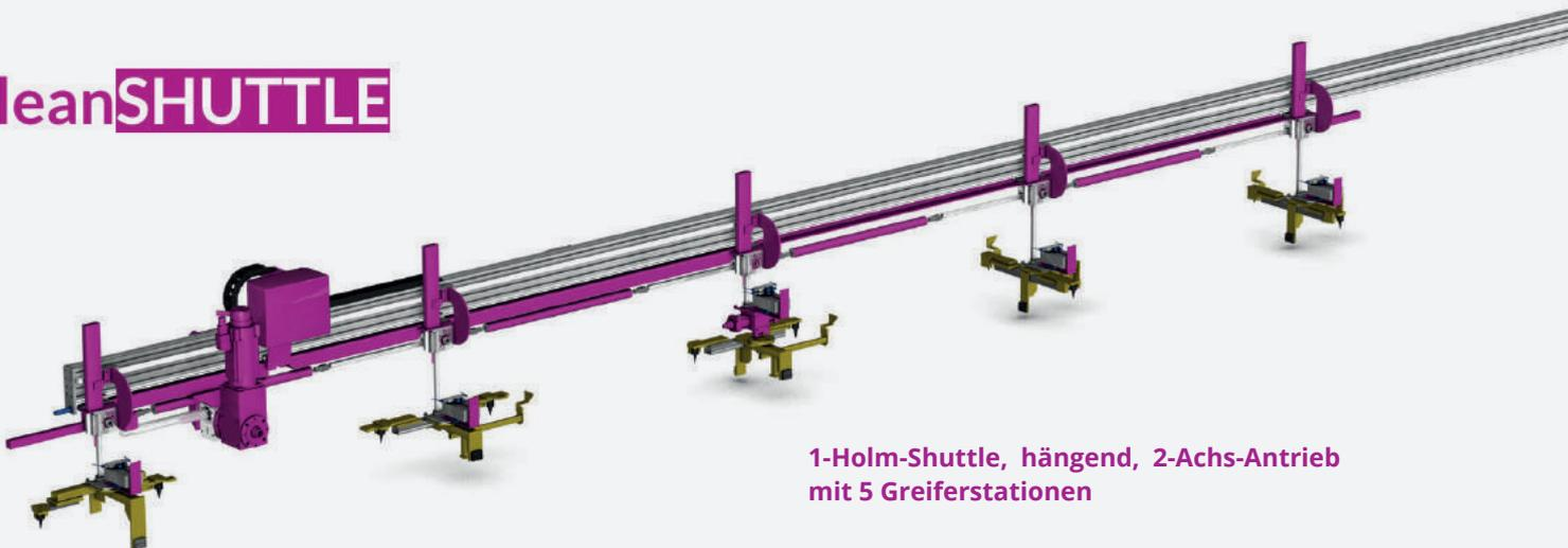
**1-Holm-Shuttle, hängend, 2-Achs-Antrieb mit 5 Greiferstationen**
