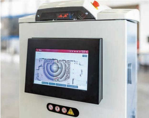
**Mithilfe der Fahrzeugsoftware Arcos beherrschen die Fahrzeuge von DS Automotion zusätzlich zum Betrieb mit Spurführung oder freier Navigation auch das kooperative und kollaborative Navigieren.**
