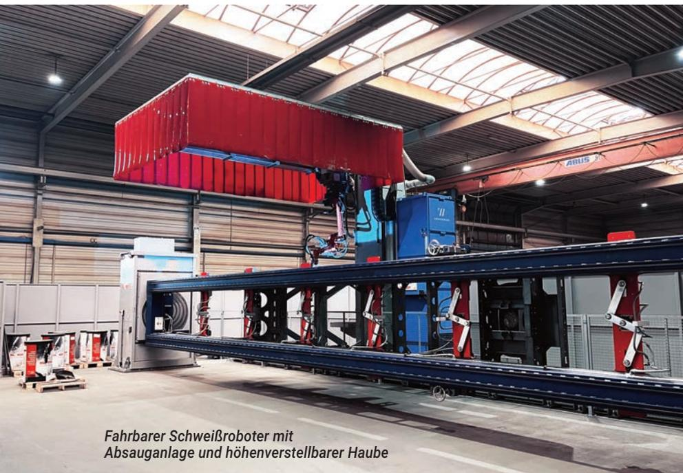
Fahrbarer Schweißroboter mit Absauganlage und höhenverstellbarer Haube
