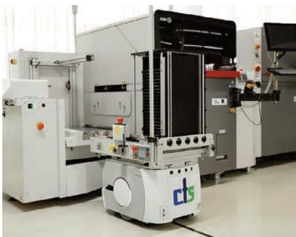
Der rollenbasierte Front- und Hecklader LD90 RGMZ übergibt PCBs an das automatisierte Ladesystem der Firma Nutek.
