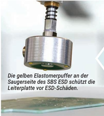
Die gelben Elastomerpuffer an der Saugseite des SBS ESD schützt die Leiterplatte vor ESD-Schäden.
