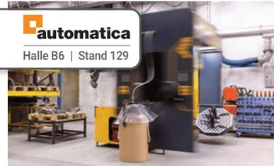
Die Anlage Cobot WeldSpace 4.0 von Demmeler eignet sich für das Lichtbogenschweißen von S235/S355- und S420-Stahlbaugruppen. Das Unternehmen Schulz Fördersysteme z.B. nutzt das System, um in der Produktion
