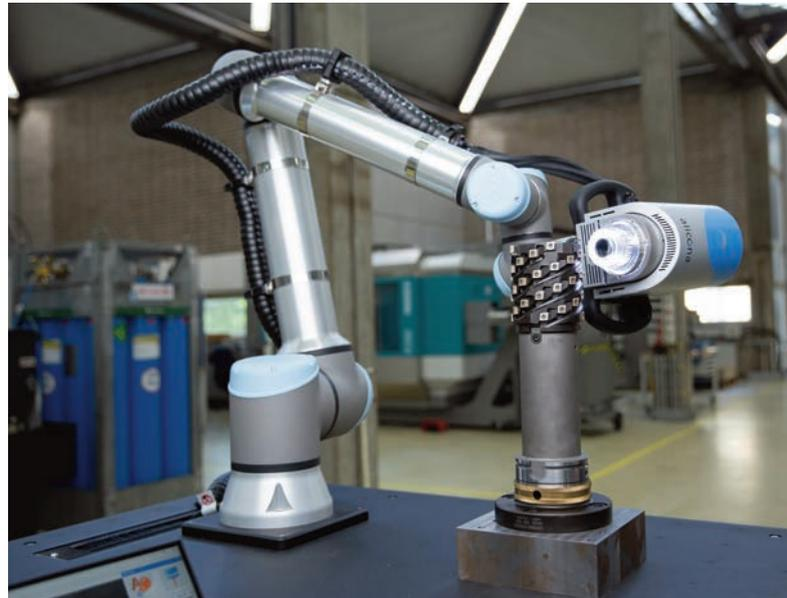
**Das IfW verwendet ein Cobot-basiertes Messsystem für die automatische Verschleißmessung mit hoher Präzision. Gemessen werden auch Mikrogeometrien auf großen Bauteilen. Ein Umspannen des Werkzeugs ist dabei nicht mehr nötig.**
