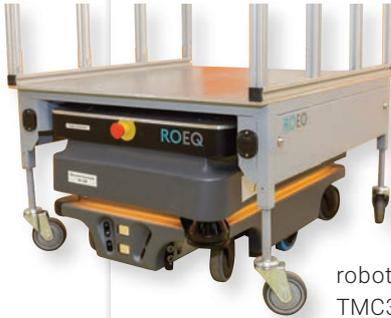
Um die Effizienz für die Produktion zu steigern, hat sich TE Connectivity entschieden, die Intralogistik mithilfe von autonomen mobilen Robotern zu automatisieren. Die Entscheidung fiel auf den Transportroboter Mir200, der mit einem TMC300-Top-Modul (einem Wagen
