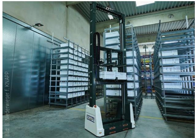
Durch die modulare standardisierte Bauweise sämtlicher Komponenten sowie den Einsatz von autonomen mobilen Robotern lässt sich Open Shuttle Store besonders einfach anpassen.
