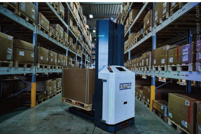
Open Shuttle Fork ist ein autonomer mobiler Roboter für den Palettentransport.
