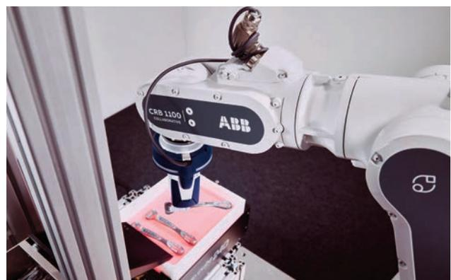
**Der Cobot Swifti von ABB kann sich mit hoher Geschwindigkeit bewegen, ohne dass die Sicherheit beeinträchtigt wird, wenn sich ein Mensch dem Roboter nähert.**
