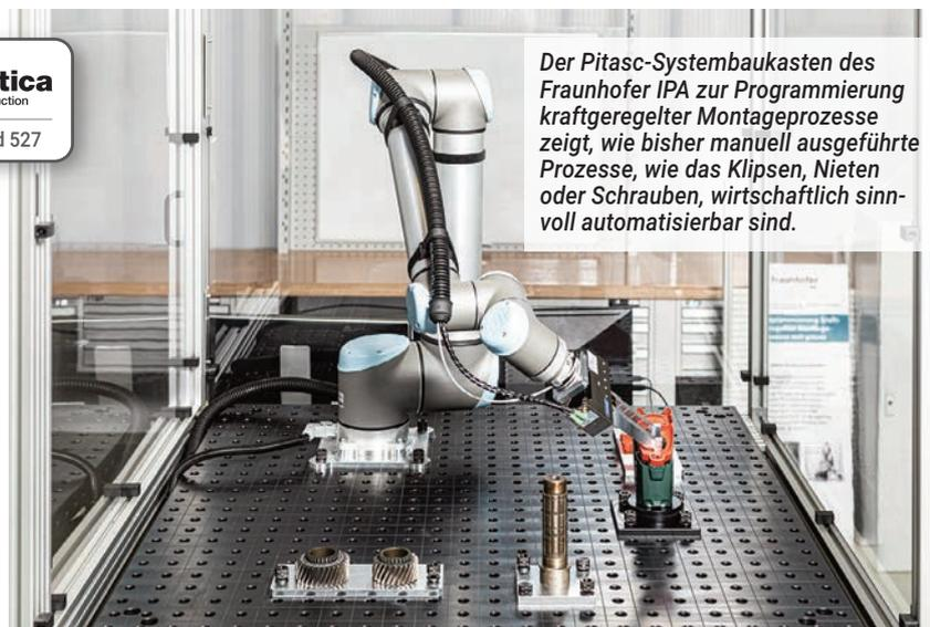
Der Pitasc-Systembaukasten des Fraunhofer IPA zur Programmierung kraft geregelter Montageprozesse zeigt, wie bisher manuell ausgeführte Prozesse, wie das Klipsen, Nieten oder Schrauben, wirtschaftlich sinnvoll automatisierbar sind.
