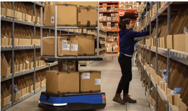
**Der mobile Cobot Chuck von 6 River Systems nutzt maschinelles Lernen und KI, um auf Grundlage der aktuellen Aufträge Arbeitsabläufe und Lagerwege in Echtzeit anzupassen.**
