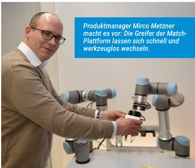
Produktmanager Mirco Metzner macht es vor: Die Greifer der Match-Plattform lassen sich schnell und werkzeuglos wechseln.
