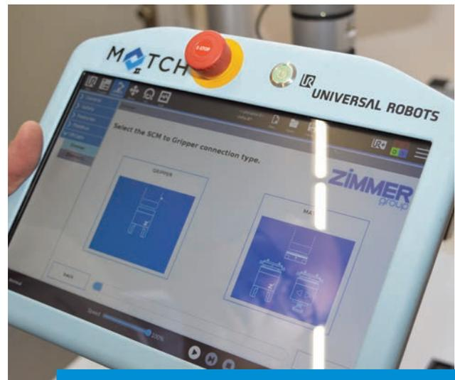
Die Comfort App zur Ansteuerung des Greifers läuft direkt auf dem Bedien-Panel des jeweiligen Roboters.
