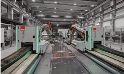
men stellt Strukturbauteile aus Verbundwerkstoffen für die Luft- und Raumfahrt her. Nun erging ein erster Auftrag über eine Accubot-Ultraschallprüfanlage für die Durchschallungsprüfung von Composite-Bauteilen an das Unternehmen Fill Maschinenbau. Das Doppelroboter-Ultraschallprüfsystem ist eine multimodale Prüfanlage mit hoher Flexibilität und Dynamik. Mit bis zu 2m/s Prüfgeschwindigkeit in Durchschallungsprüfung wird die Produktivität und Zuver-
