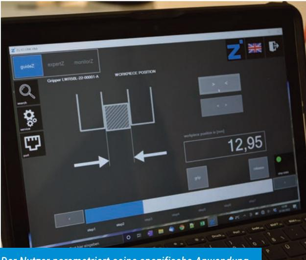
Der Nutzer parametriert seine spezifische Anwendung mit wenigen Klicks exakt nach Maß.
