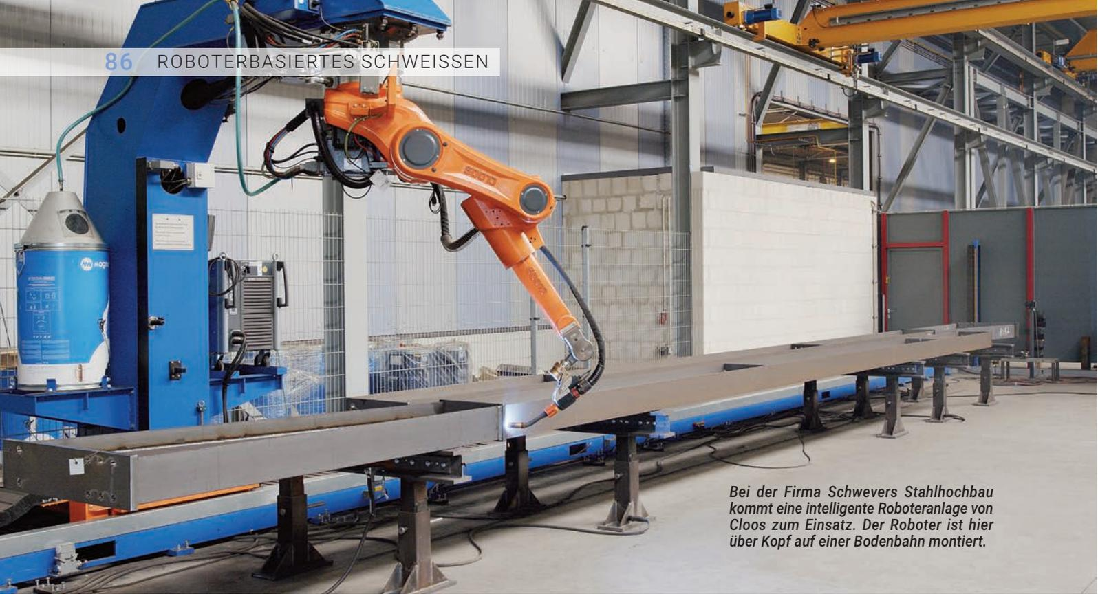
Bei der Firma Schwevers Stahlhochbau kommt eine intelligente Roboteranlage von Cloos zum Einsatz. Der Roboter ist hier über Kopf auf einer Bodenbahn montiert.
