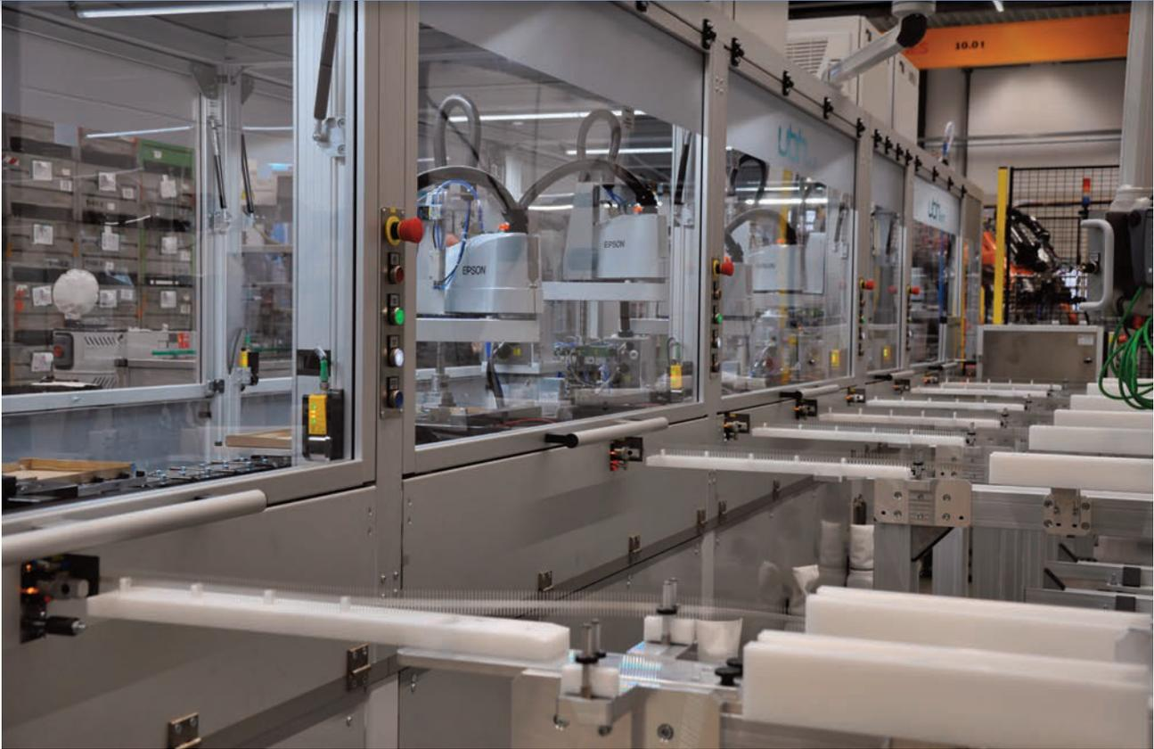
*Schnelle Zuführung für präzise Positionieraufgaben: Die neue Anlage von UBH fertigt bis zu 2,6 Millionen spritzgegossene Stecker pro Jahr.*
