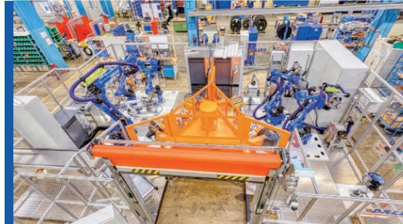
**Für einen namhaften Automobilhersteller konzipierte und fertigte Dalex mehrere Roboterschweißanlagen zum Schweißen von Abgasstrangisolierungen. Ein wichtiger Bestandteil der Anlagen, um den Produktionsablauf komplett zu automatisieren, ist die gemeinsam mit Kyokutoh entwickelte vollautomatische Nachbearbeitungseinheit.**
