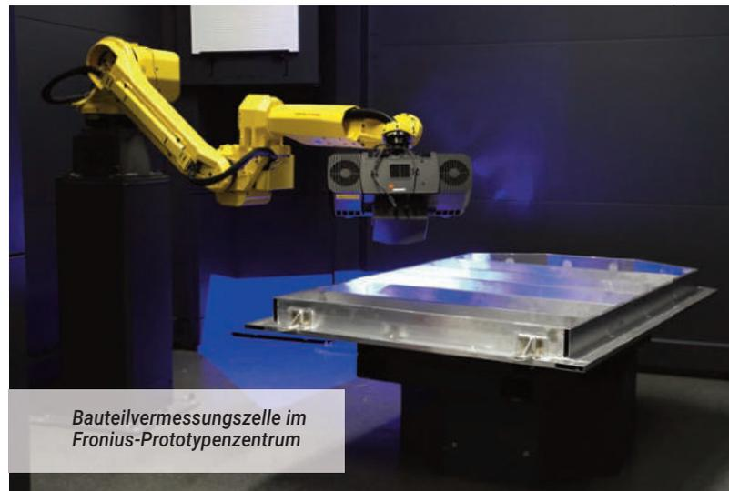
Bauteilvermessungszelle im Fronius-Prototypenzentrum
