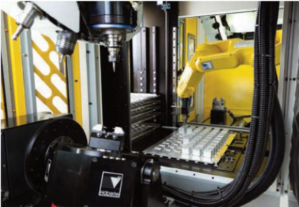
Mit dem Fünfdrehstisch lassen sich die eng tolerierten Maße für Käfer-Messuhren in einer Aufspannung bearbeiten.
