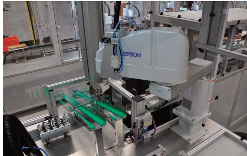
**Auch in der Packstation ist ein Scara-Roboter für das Handling zuständig.**
