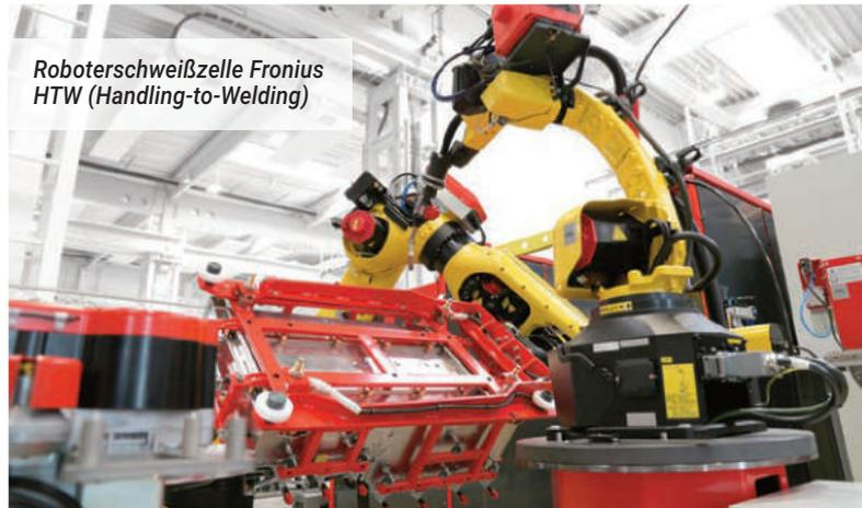
Roboterschweißzelle Fronius HTW (Handling-to-Welding)
