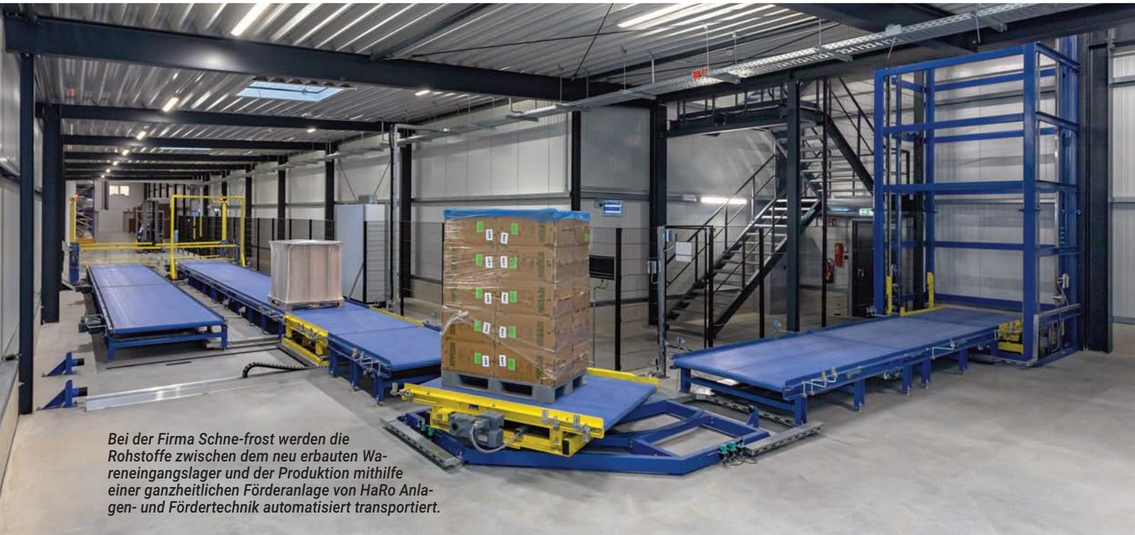
Bei der Firma Schne-frost werden die Rohstoffe zwischen dem neu erbauten Wareneingangslager und der Produktion mithilfe einer ganzheitlichen Förderanlage von HaRo Anlagen- und Fördertechnik automatisiert transportiert.
