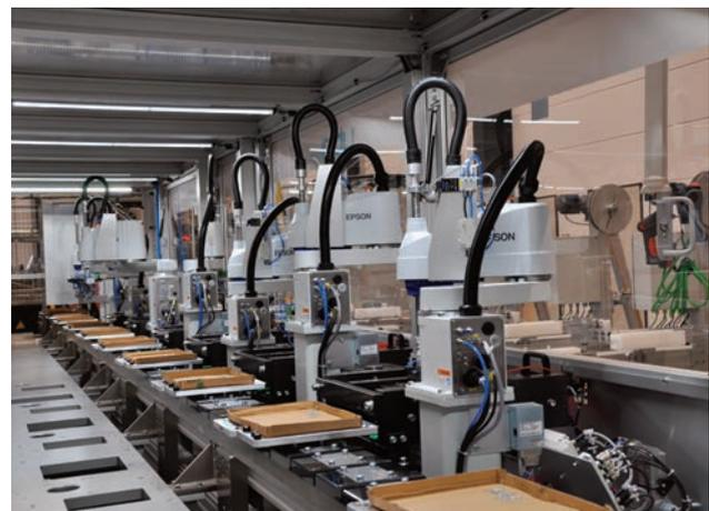
**Sieben Scaras auf einen Streich: Die Positionieranlage im Leistungstest (noch vor der Bestückung mit Werkstückträgern).**
