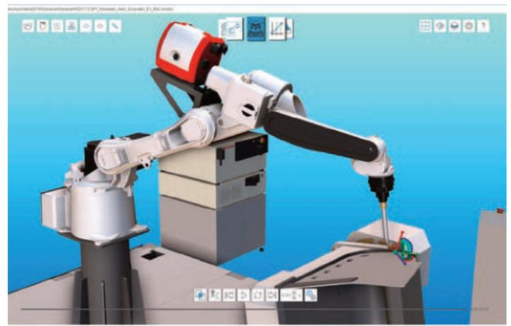
**Mit K-Virtual von Kawasaki Robotics lassen sich Schweißroboteranwendungen offline programmieren und vorab per digitalem Zwilling simulieren.**
