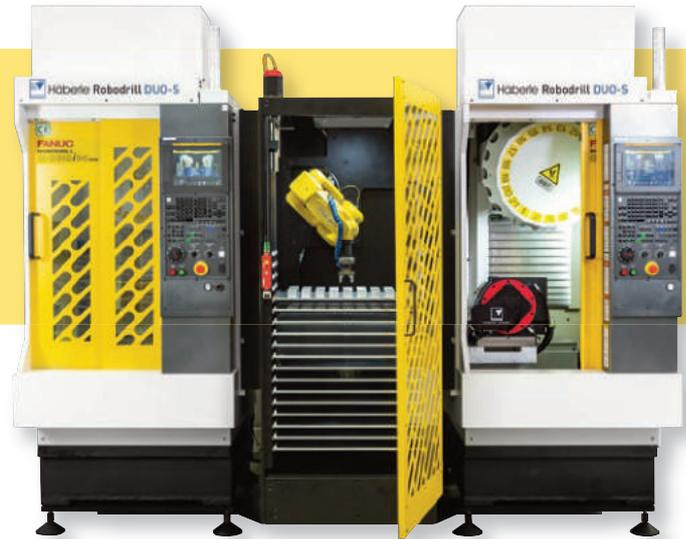
Für den Messuhrenhersteller Käfer wurden die Robodrill-Maschinen mit einem Drehtisch von Häberle zur Fünfachsbearbeitung ausgerüstet.
