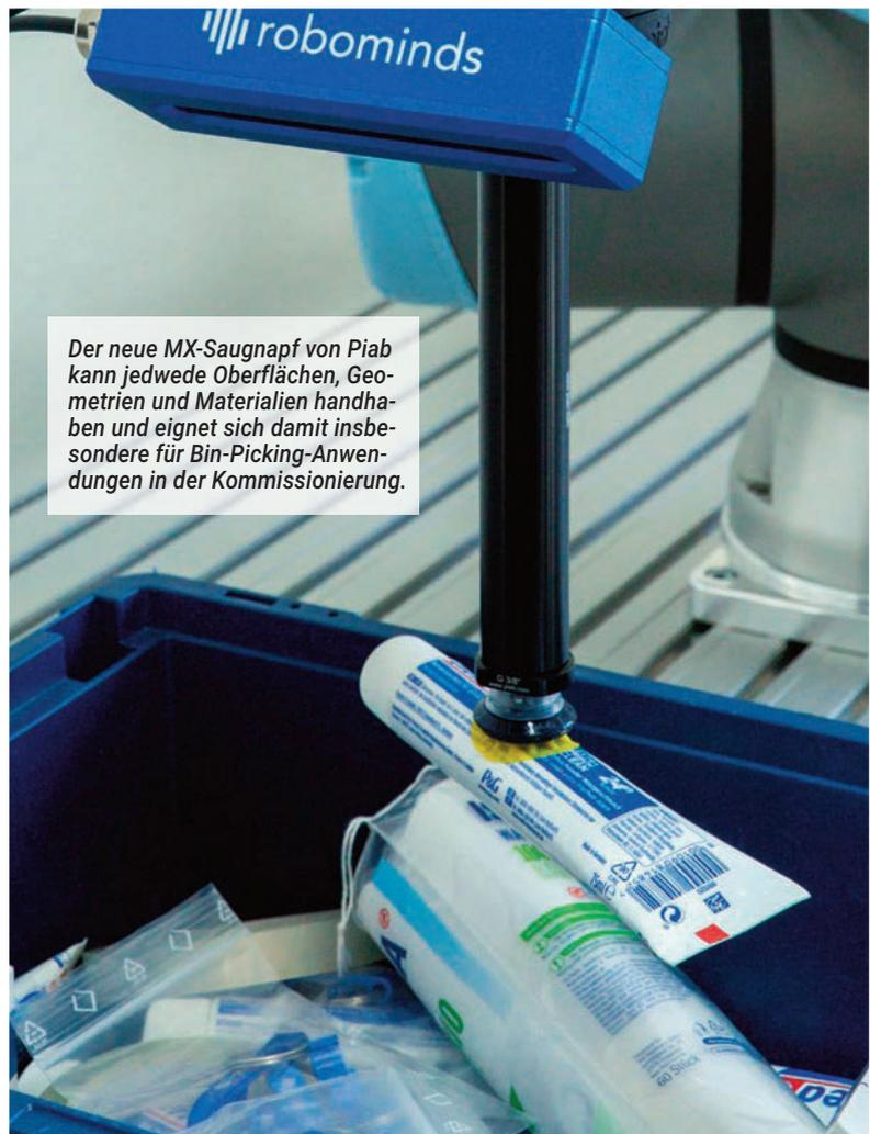
*Der neue MX-Saugnapf von Piab kann jedwede Oberflächen, Geometrien und Materialien handhaben und eignet sich damit insbesondere für Bin-Picking-Anwendungen in der Kommissionierung.*
