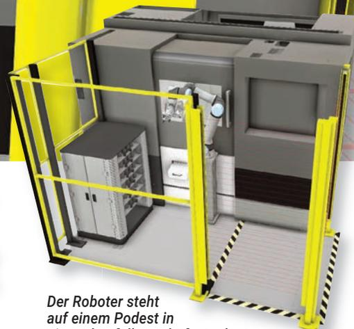
Der Roboter steht auf einem Podest in einer ebenfalls exakt festgelegten Position zur Werkzeugmaschine.
