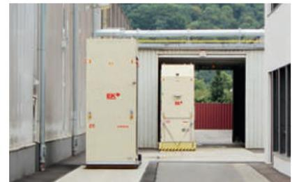
*Induktive Spurführung im Outdoor-Bereich: Die Sensoren des FTS von EK Robotics orientieren sich an dem im Boden verlegten Leitdraht.*
